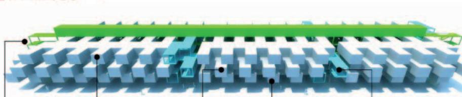
En el centro del conjunto, los módulos de vivienda y de recreación, se encuentran conectados por los módulos de acceso y comunicación, los cuales se forman con la medida del módulo base que es 3.30 x 9.30 x 3.00 mts.
