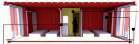
El módulo que forma parte de un conjunto, también está conformado por módulos prefabricados con funciones específicas para la vivienda y el resguardo humano, tales como MODULO ENVOLVENTE, MÓDULOS DE VENTILACIÓN, MÓDULOS DE COMER-ESTAR, MÓDULOS DE DORMIR-GUARDADO, MODULO DE BAÑO, MÓDULOS DE DIVISIÓN
