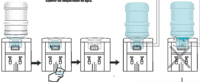
Si no sigue las instrucciones el receptor agua caliente podría ahogarse y causar posibles derramamientos de agua como se muestra.
